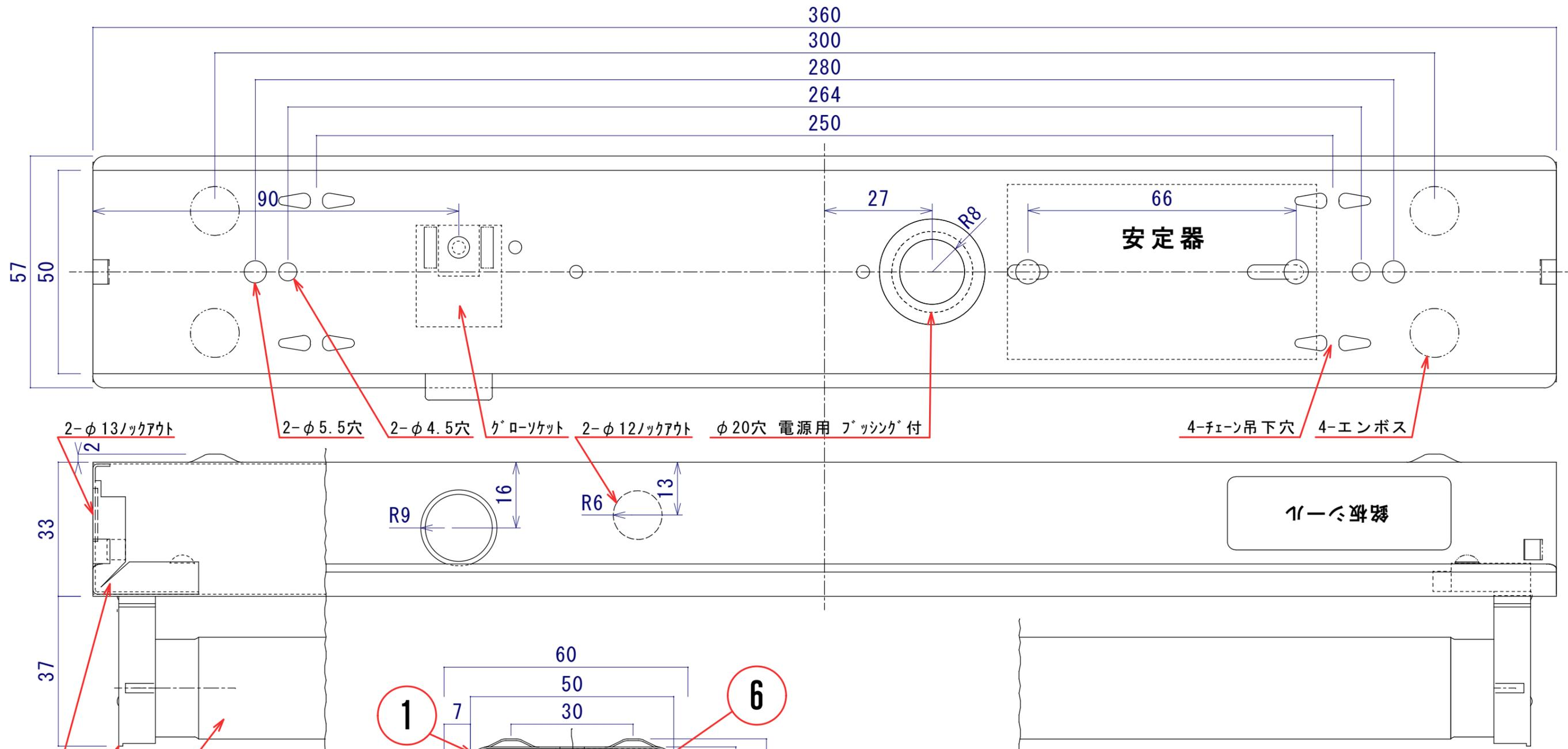
2-φ13ノックアウト 2-φ5.5穴 2-φ4.5穴 グローソケット 2-φ12ノックアウト φ20穴 電源用 フッシク付
