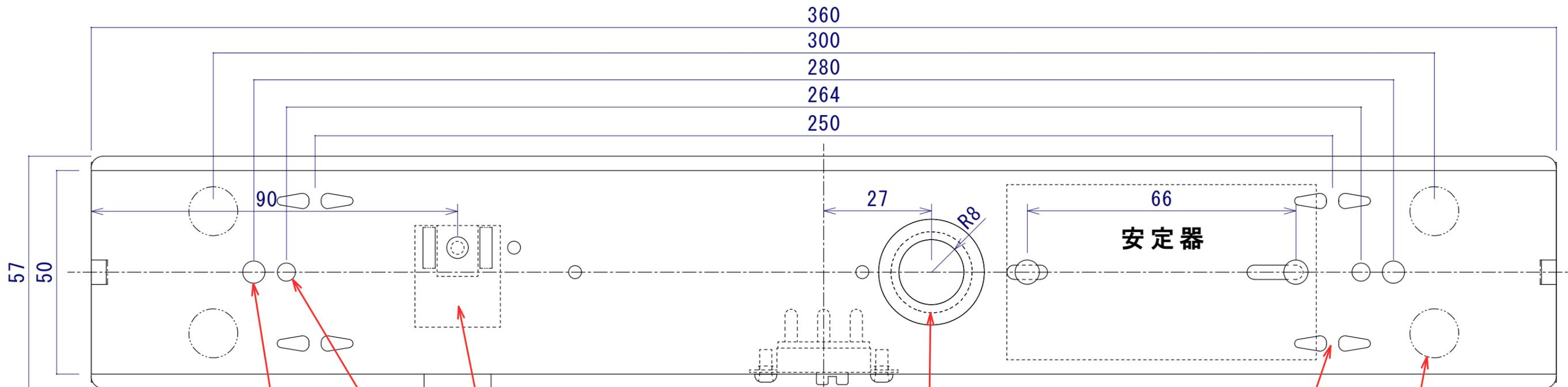
2-φ13ノックアウト    2-φ5.5穴    2-φ4.5穴    グローソケット    2-φ12ノックアウト    φ20穴 電源用 フッシク付    周波数切替表示シール    4-チェーン吊下穴    4-エンボス
